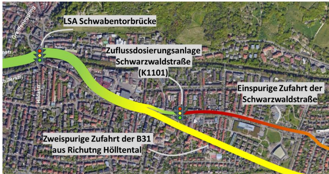
Abbildung 15 Übersichtsplan bei Zuflussdosierung auf der Schwarzwaldstraße
